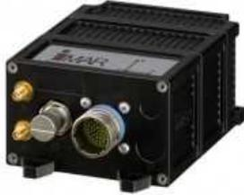
IMU Einheit mit MEMS (Halbleiter)
